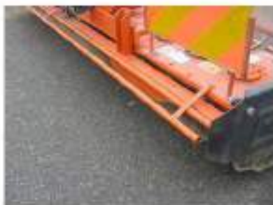
Fig. 15 - protezione frontale conforme arpi a rotativo
