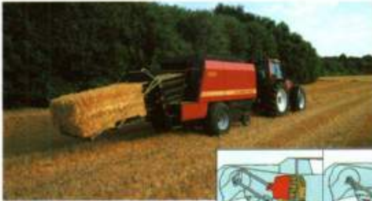
Proceso de llenado de la cámara principal en una empacadora para grandes pajas prismáticas.
