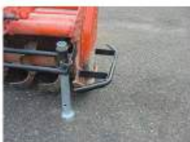
Fig. 17 - protezione conforme: laterale a barriera posizionata ad una quota superiore a 200 mm
