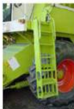
Scala protetta e gradini con superficie antiscivolo
