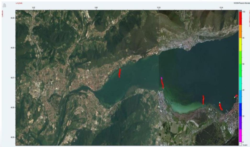
Mappa delle Coperture in % della vegetazione acquatica rilevate il 10 10 2016 con lo strumento echosounder MX Bio-sonics
