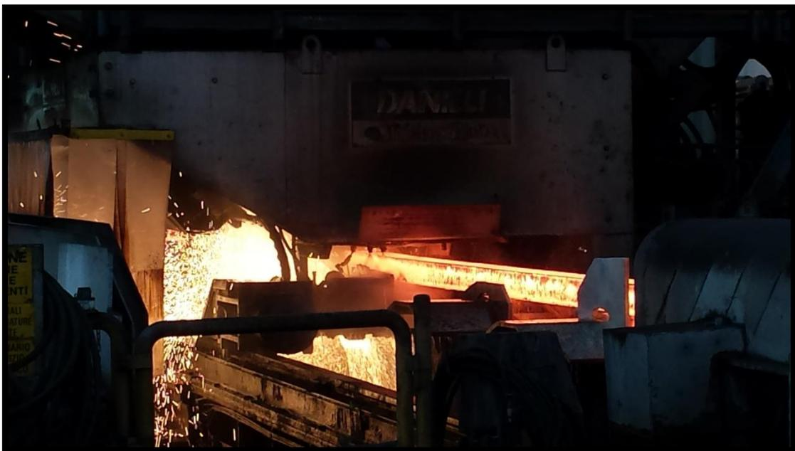
Figura 8 \_una fase della laminazione a caldo (riduzione della billetta)
