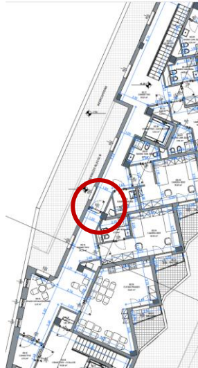
Figura 4 - Stralcio tavola progetto esecutivo - Inserimento porta in prossimità della (ex scala C) scala B2
